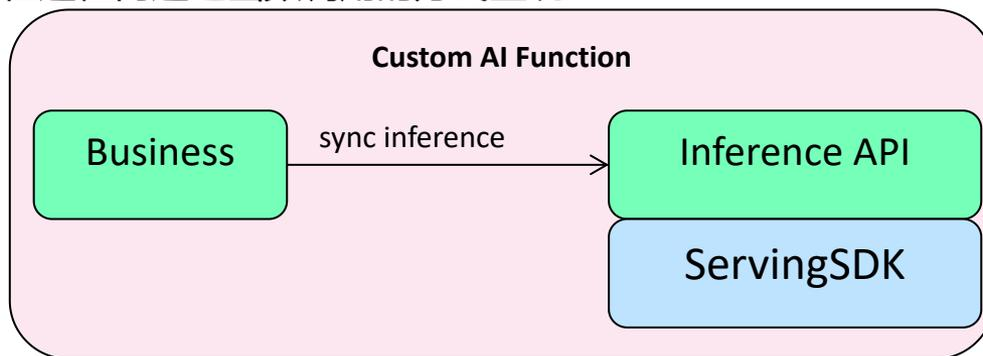
网络App可以使用SDK API，在一个进程内以函数调用的方式完成推理
